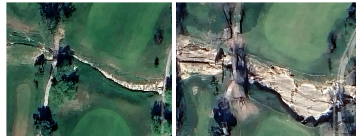
Figura 8. Evolución de la socavación de las márgenes (may.2023-feb.2024).
